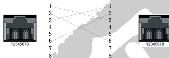
图 3-7、以太网 RJ45 交叉接线示意图
