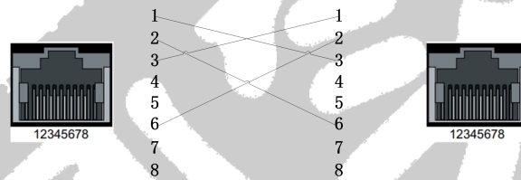
图 2-7、以太网 RJ45 交叉接线示意图
