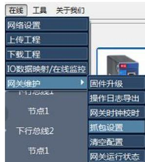
点击在线-网关维护-抓包设置-扫描在线网关
