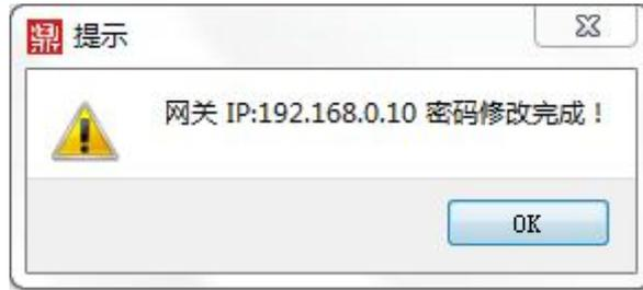
当提示修改成功后代表已将新密码传送给所选网关，在执行以上在线操作需输入密码。输入错误提示“密码错误请重试”，正常后进行对应操作。
