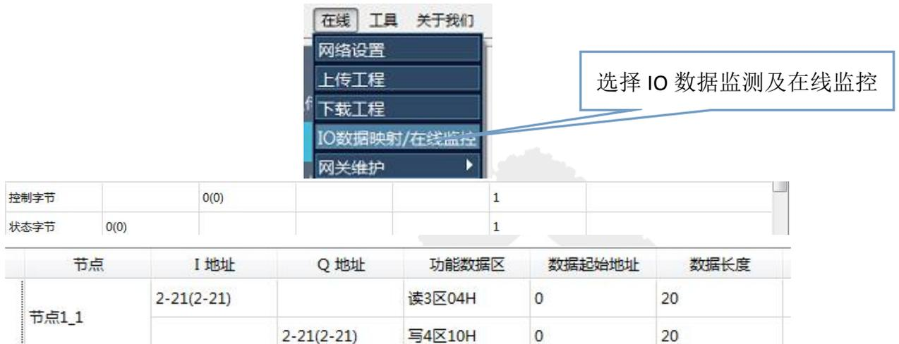
如 com1 控制字节 PN 侧 I 地址 0，控制字节 Q 地址 0，节点 1 读取 3 区起始寄存器地址 0，10 个寄存器，对应分配 PN 侧 I 区相对地址为 2-21 字节，如写 4 区 10 个寄存器起始寄存器地址 0，连续写 10 个寄存器，对应分配 PN 侧 Q 区相对地址为 2-21 字节，
