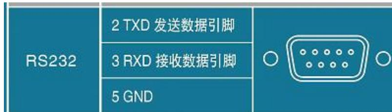
RS232 公（针）接口，接不同设备注意使用的 232 串口线引脚定义，
