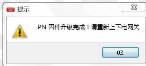
点击 OK 模块自动重启启动 PN 固件升级，SF 红色闪烁同时 PNBFSF 绿色交替闪烁代表升级中，升级成功后 SYS 红色闪烁 PNBFSF 停止绿色闪烁，重新上电模块即可进入工作模式。
