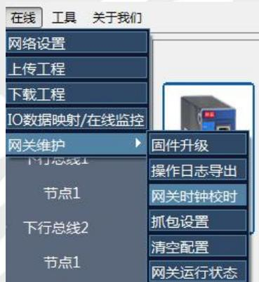
当前时间与 PC 时间同步更新，点击刷新按钮可读取一次网关系统时间显示在网关时间列，当误差较大时，点击校时按钮，可把当前 PC 时间设置到网关中，再次点击刷新按钮回读网关时间，检查是否设置成功。
