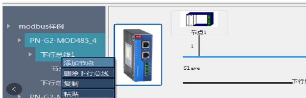
双击节点弹出节点属性，可设置下行接口作为 modbus 从站的站地址，可设置 1-247。下行总线 1 节点站地址设置为 1，点击保存。
