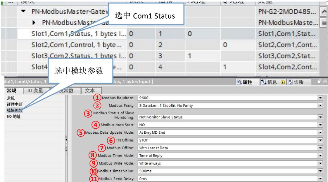
(1) Modbus Baudrate: MODBUS 测试波特率 1200 到 115.2K 可选。
