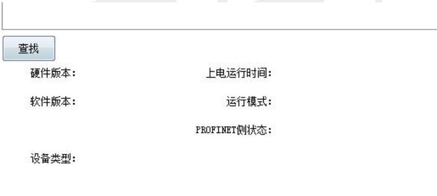
则会刷出在线网关的软硬件固件版本号、设备类型、上电运行时间、运行模式以及 PN 侧运行状态
