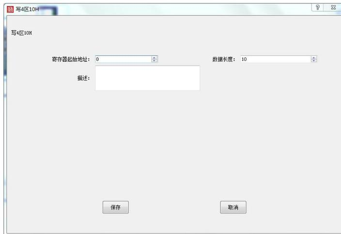
点击保存即可，在下方生成 modbus 与 PN 之间的 IO 映射相对地址，读 30001-30010 将映射到 PN 侧相对地址 IB3-22，写 40001-40010 将映射到 PN 侧相对地址 QB2-21。
