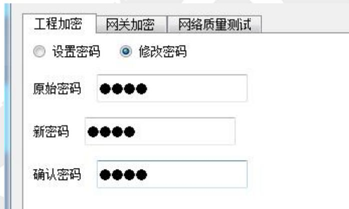
**网关加密设置：**是对网关在线操作时进行的安全验证，以防人为误操作下载或非法人员恶意下载配置工程。主要加密环节包括：下载工程、上传工程、升级固件、日志导出、抓包设置 清空配置以及网关状态有效。当网关设置密码后以上操作只有密码认证成功后才执行相关操作。**遗失后无法找回。**
