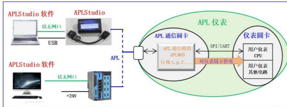
图7.4：APLMODE用于一个APL仪表开发系统的举例
